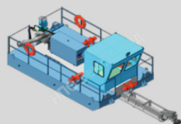
Земснаряд Д-110/47-И-Ф 435 м 3 в час / 27 м.вод.ст.
